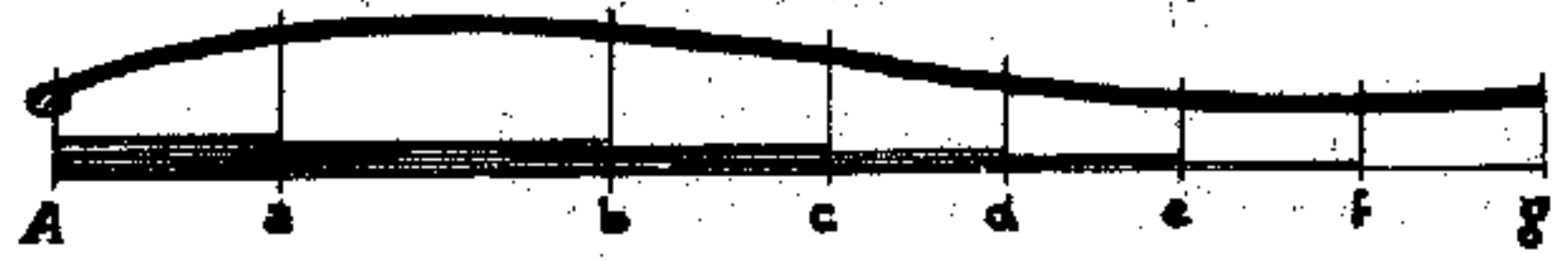
PERFIL DE LAS DIFERENTES COSTILLAS (HACER DOS DE CADA UNA) EN MADERA Balsa Dura DE 1mm. DE ESPESOR
